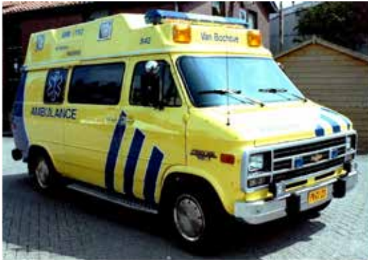
Afbeelding 8. Chevrolet Chevy Van met een Vanguard 2-carrosserie van Wheeled Coach met de striping van SAVE van de ambulancedienst Van Bochove uit Harderwijk (bron: Kees Verhoef, Katwijk aan Zee).
